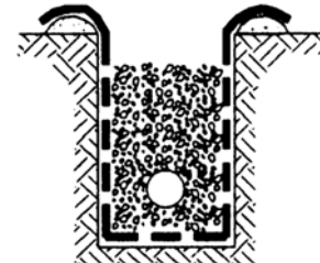
۴- ریختن مصالح زهکشی و تراکم
