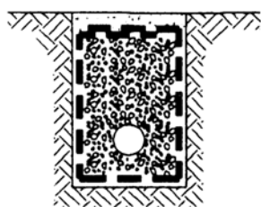
۶- اجرای خاکریز باقیمانده روی کانال و تراکم
